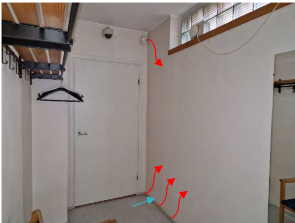
Kuva 74 Merkkiaineen laskupaikka esitetty sinisellä nuolella. Eteisen 1.24 puolella olevat ilmapuotokohdat esitetty punaisilla nuolilla.
