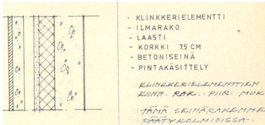
Kuva 3 Klinkkeripintaisen ulkoseinän rakennetyyppi alkuperäisten suunnitelmien mukaan.
